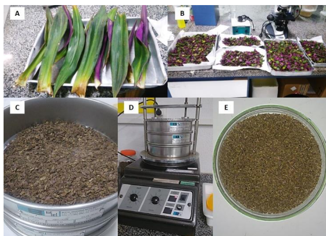
Figura 9: Fotografias do processo de preparo da amostra: (A) folhas de Tradescantia spathacea após lavagem e secagem; (B) folhas frescas cortadas e acomodadas em recipientes para secagem; (C) folhas secas preparadas para granulometria; (D) peneirador mecânico com peneiras da série Tyler 18-32 mesh ; (E) amostra com 18-32 mesh . Fonte: Arquivo próprio, 2018.
