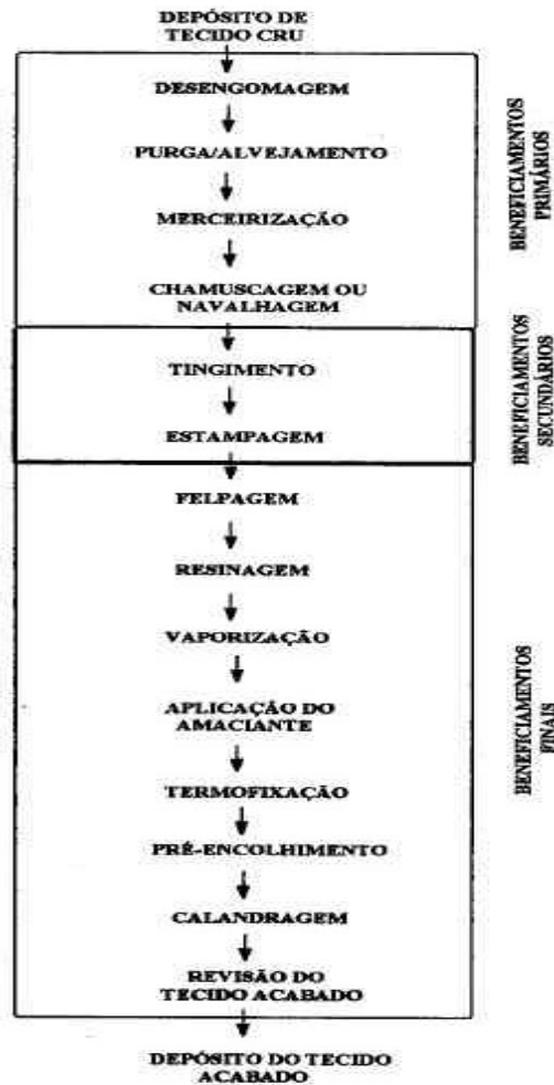
Figura 1. Fluxograma do beneficiamento têxtil (KUNZ, 1999 apud LIMA, 2004)
