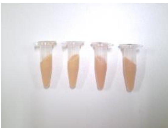
Creme Lanette® centrifugado a 35°C, 5000 RPM em 10 min.
