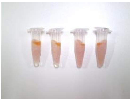
Creme polawax® centrifugado a 33°C, 5000 RPM em 10 min.
