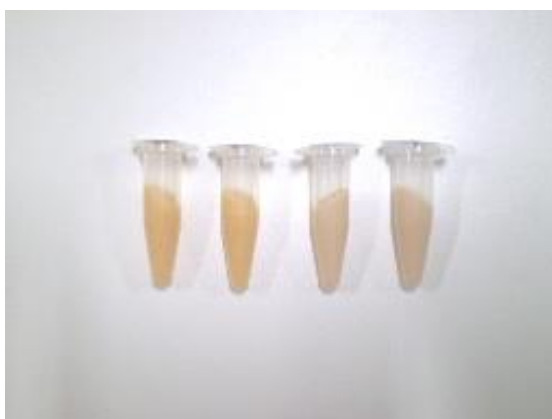
Creme – gel Hostacerin® centrifugado a 35°C, 5000 RPM em 10 min.
