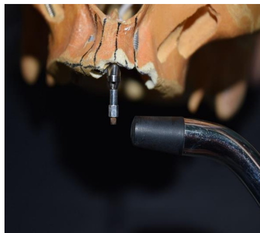
Figura 20: Avaliação da análise de frequência de ressonância do mini-pilar protético 3,5 mm de comprimento agulado 30° instalado em maxila edêntula sintética. Sonda do Osstell® aproximada a extremidade do SmartPeg® no sentido méso-distal para obtenção dos valores de ISQ.
