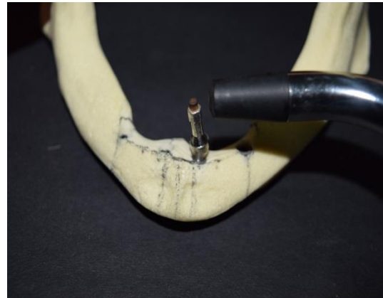
Figura 24: Avaliação da análise de frequência de ressonância do mini-pilar protético 3,5 mm de comprimento angulado 30° instalado em mandíbula edêntula sintética. Sonda do Osstell® aproximada a extremidade do SmartPeg® no sentido méso-distal para obtenção dos valores de ISQ.
