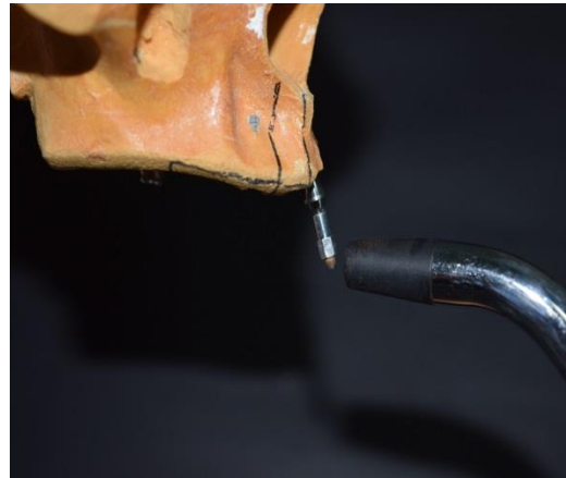
Figura 19: Avaliação da análise de frequência de ressonância do mini-pilar protético reto 5,5 mm de comprimento instalado em maxila edêntula sintética. Sonda do Osstell® aproximada a extremidade do SmartPeg® no sentido vestibulo-palatino para obtenção dos valores de ISQ.
