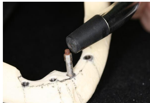
Figura 16: Avaliação da análise de frequência de ressonância dos implantes instalados em mandíbula edêntula sintética. Sonda do Osstell®
