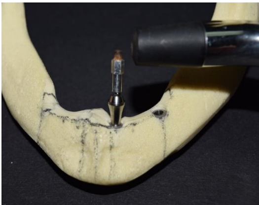
Figura 22: Avaliação da análise de frequência de ressonância do mini-pilar protético reto com 5,5 mm de comprimento instalado em mandíbula edêntula sintética. Sonda do Osstell® aproximada a extremidade do SmartPeg® no sentido méso-distal para obtenção dos valores de ISQ.
