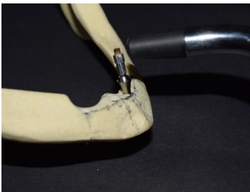
Figura 23: Avaliação da análise de frequência de ressonância do mini-pilar protético reto com 5,5 mm de comprimento instalado em mandíbula edêntula sintética. Sonda do Osstell® aproximada a extremidade do SmartPeg® no sentido méso-distal para obtenção dos valores de ISQ.
