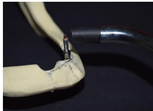
Figura 25: Avaliação da análise de frequência de ressonância do mini-pilar protético 3,5 mm de comprimento angulado 30° instalado em mandíbula edêntula sintética. Sonda do Osstell® aproximada a extremidade do SmartPeg® no sentido vestibulo-palatino para obtenção dos valores de ISQ.
