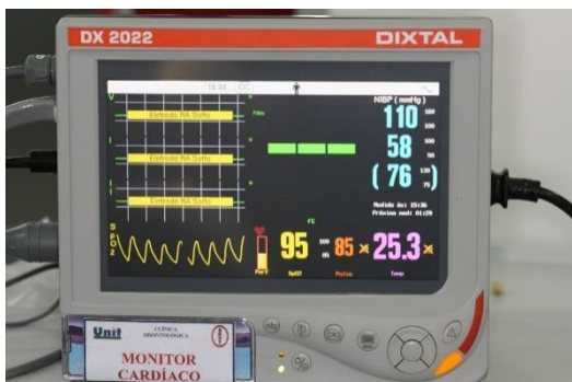
Figura 5. Monitoramento multiparamétrico de pressão arterial não invasiva, frequência cardíaca e oximetria
