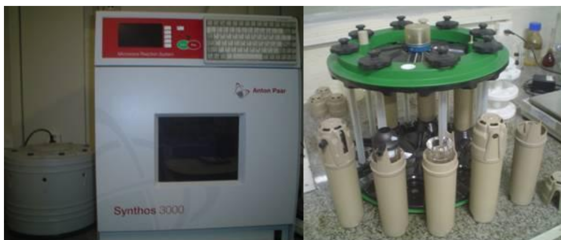
Figura 14: Reator micro-ondas Synthos 3000, base giratória e tubos de quartzo.
