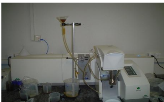
Figura 17: Equipamento para determinação da DTG - modelo MASTERSIZER 2000 da MALVERN.
