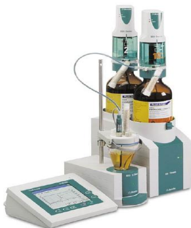
Figura 16: Sistema de análise do teor de água baseado no método de titulação potenciométrica empregando reagente de Karl Fischer.
