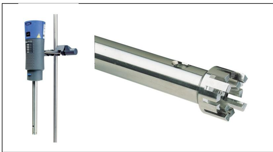
Figura 13: Equipamento de geração de emulsão – homogeneizador ULTRA-TURRAX.
