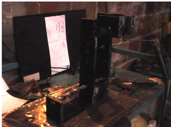
Figura 3.88. Processo de soldagem das peças do suporte principal do sistema de pêndulo.
