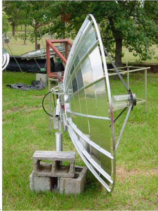
Figura 2.5. Concentrador Fresnel construído por Franco et al. (2004)
