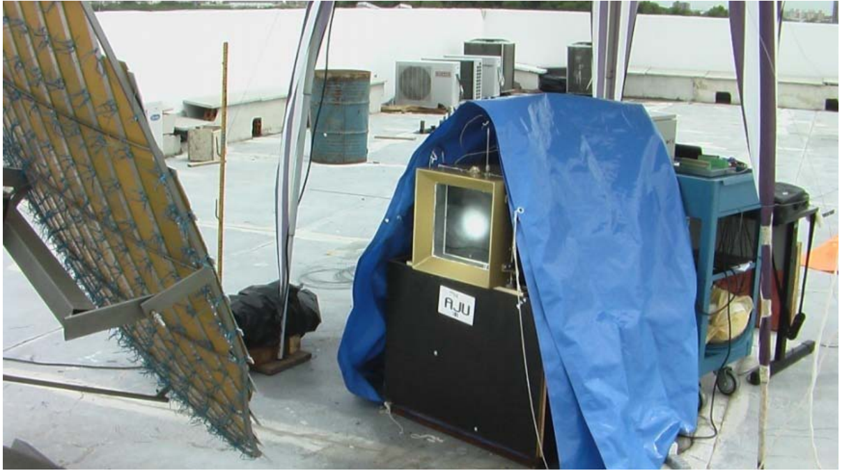
Figura 3.129. Sistema de forno com concentrador solar em aquecimento.
