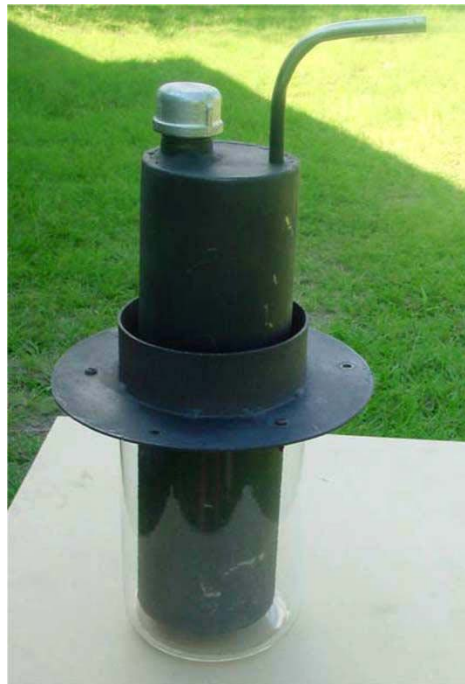
Figura 2.6. Ebulidor de aço inox pintado de preto (FRANCO et al., 2004).
