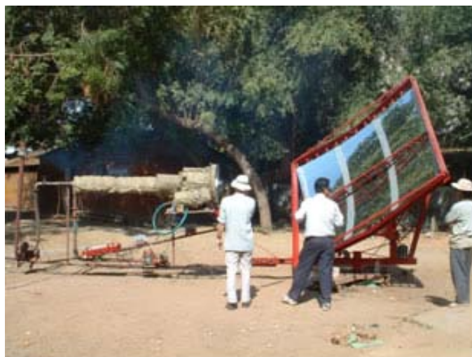
Figura 2.14. Crematório com sistema de aquecimento solar. (SCHEFFLER, 2006b).
