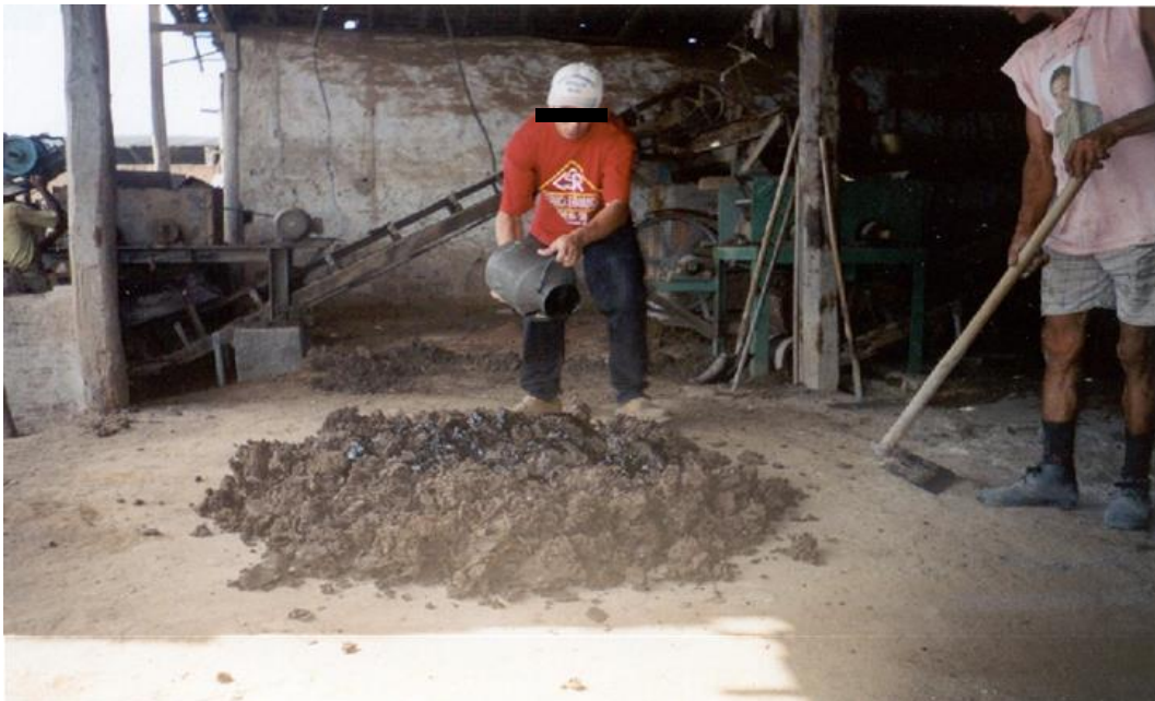
Figura 10 - Incorporação manual da borra oleosa à massa argilosa.
