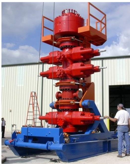
Figura 4: Blow out Preventer – BOP Fonte: RANGEL, 2015.
