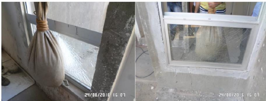
Figura 16 – Esquadria após o ensaio.
