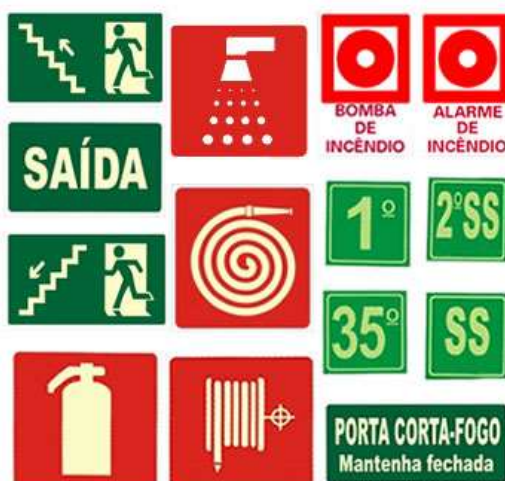
Figura 06 - Exemplos de sinalização de emergência
