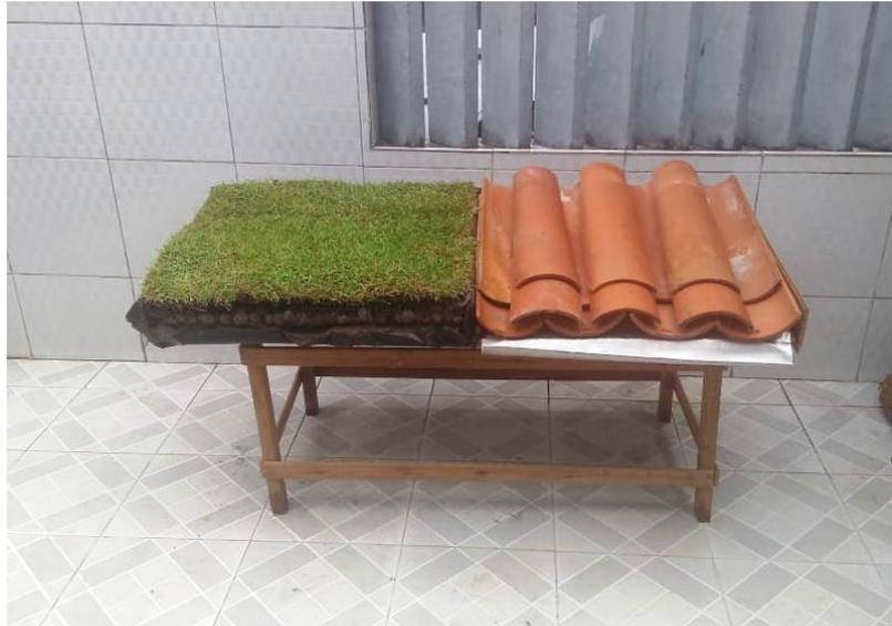
Diante da necessidade do equipamento para medição da precipitação pluviométrica no protótipo, optou-se por realizar os testes com simulações controladas através de regador, eliminando a possível variação da vazão pluviométrica para os dois protótipos. Mesmo se tratando de dois protótipos trabalhando na mesma superfície, existiu a incerteza de que em cada protótipo, o volume de água fosse o mesmo.
