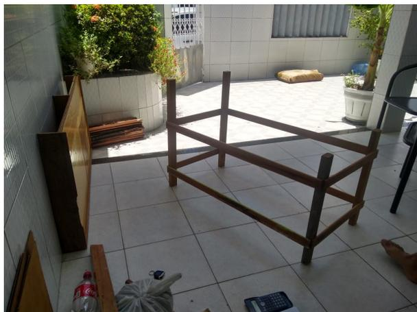
O protótipo para o experimento de campo foi formado por uma caixa retangular, com dimensões 1,30m x 0,60m e 0,10m de altura. Essa caixa foi dividida em duas partes com seções quadrada de 0,40m<sup>2</sup> de área de fundo. A estrutura foi montada sobre uma base de madeira compensada com espessura de 2,5cm, para suportar a estrutura do telhado montado.
