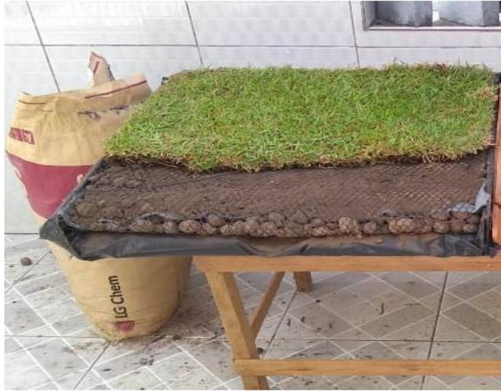
Conclui-se a montagem do telhado verde, a Figura 22 detalha a apresentação das camadas que compõem o telhado verde intensivo, já que o mesmo teve a terra vegetal maior que 15 mm, ficando com 20 mm de camada para a terra vegetal.
