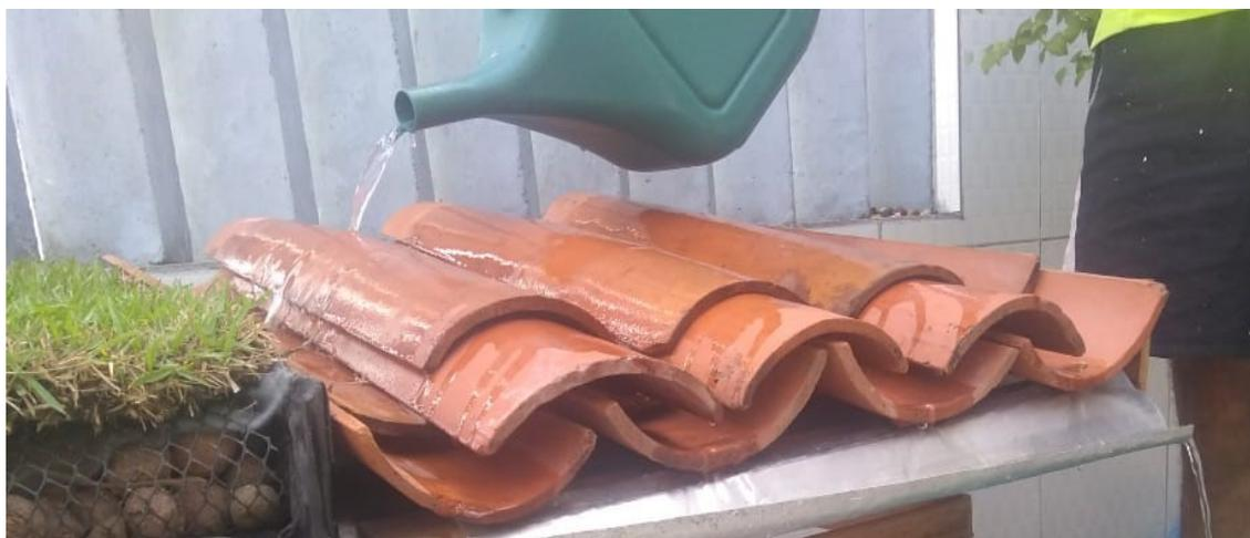
Para os testes, o volume e a vazão de água utilizada para os dois protótipos foram iguais, para que não houvesse interferência nos dados finais e a inclinação da estrutura do telhado verde com 10% e telhado convencional com 12% para todas as seções na simulação da precipitação pluviométrica realizadas no experimento no intervalo de 60 minutos.
