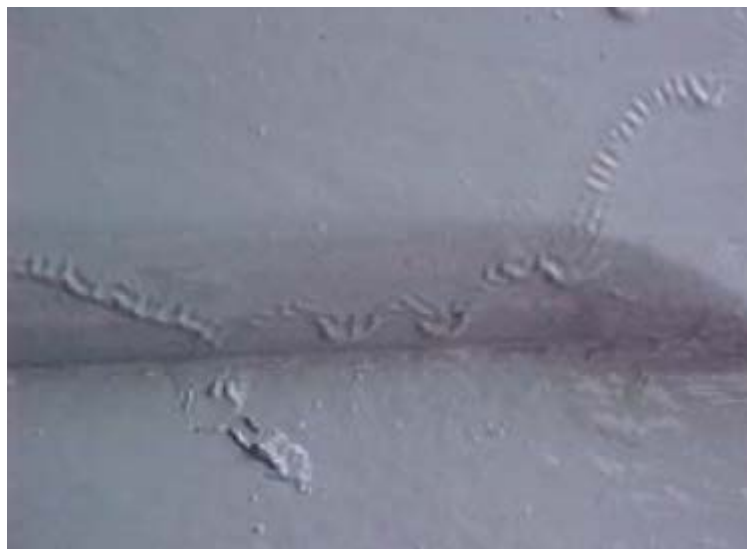
Figura 17 – Exemplo de enrugamento em pintura.
