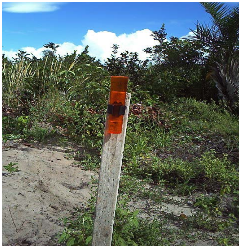
Foto 1: Instalação do Pluviômetro no dia 30/03/2008
