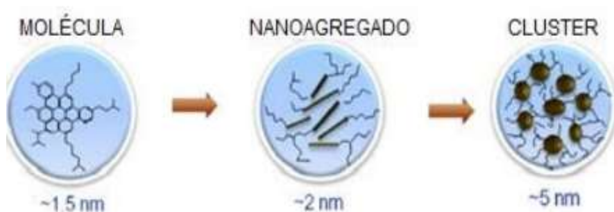
Figura 2: Modelo de Yen-Mullins que incorpora a estrutura da molécula, o nano agregado e o cluster de moléculas de asfaltenos ( adaptado de MULLINS, 2010).
