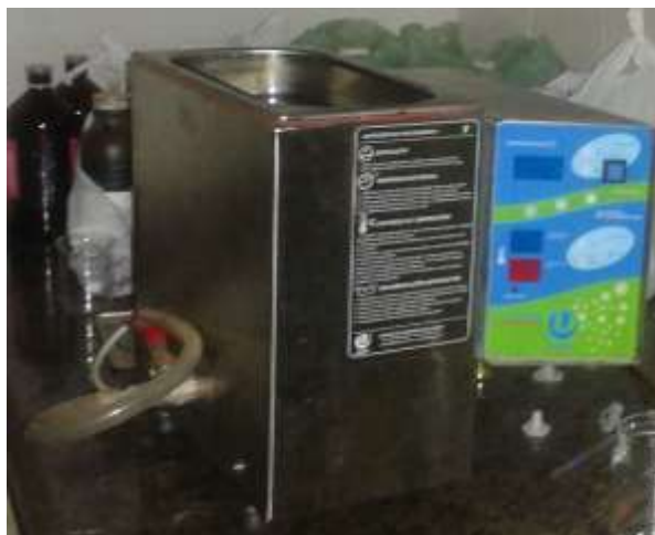
Figura 19: Equipamento do tipo sonicador utilizado para homogeneizar as amostras.
