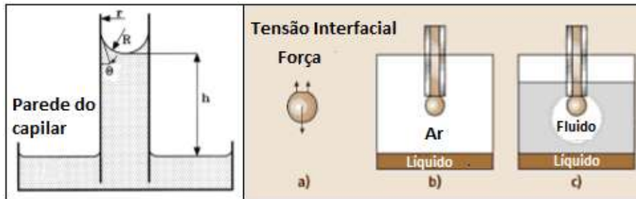
Figura 10: Método da ascensão capilar (à esquerda); (a-c) Método do peso ou volume da gota (à direita); (a) Aproximação ao balanço de forças; (b) Medição da tensão superficial; (c) Medição da tensão interfacial (à direita) ( adaptado de DRELICH et al. , 2002; TROPEA et al. , 2007).
