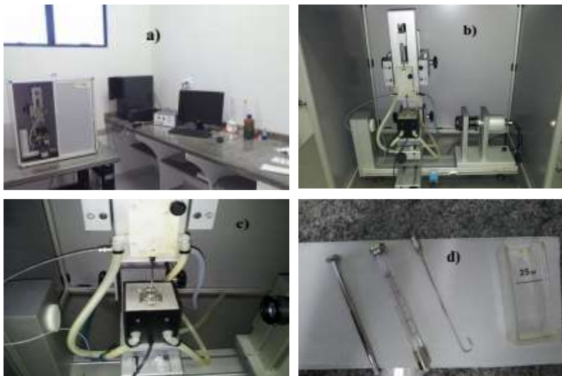
Figura 22: Visão real do tensiômetro e dos seus componentes disponível no laboratório do NUESC. a) sistema tensiômetro/computador. b) imagem do conjunto completo do tensiômetro; c) imagem do conjunto cubeta/seringa e da câmera CCD. d) seringa, cubeta e agulha em formato U.
