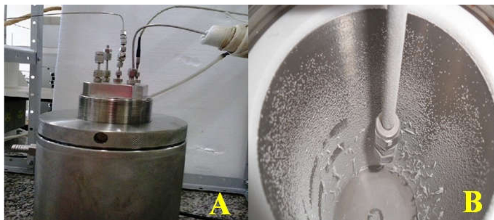
Figura 20: Fotografia mostrando a câmara de precipitação com volume de aproximadamente de 635 cm 3 conectada as linhas da unidade experimental (A) e a SiO 2 na parte interna da câmara de precipitação (B).
