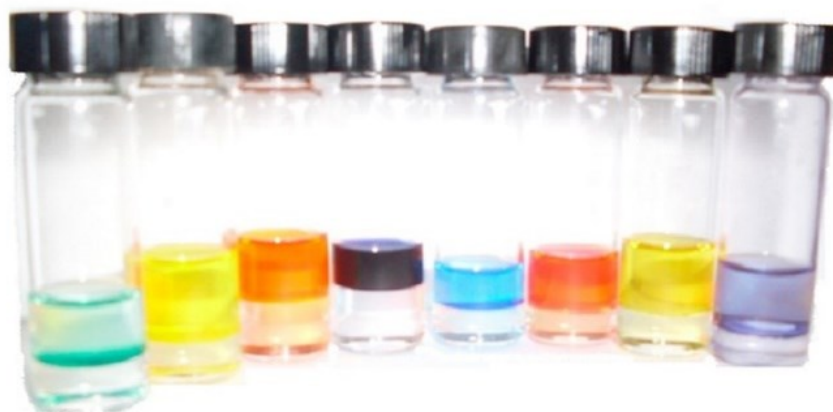
Figura 10: Sistemas ternários formados por tampão biológico HEPES + diferentes solventes orgânicos: THF, 1,3-dioxolano, 1,4-dioxano, 1-propanol, 2-propanol, terc-butanol, acetonitrila e acetona da esquerda para a direita, respectivamente. Adaptado de TAHA et al. (2012a).
