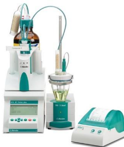
Figura 20: Sistema de análise do teor de água baseado no método de titulação potenciométrica empregando reagente de Karl Fischer.
