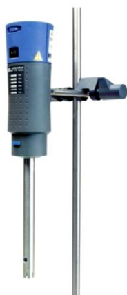
Figura 19: Geração de emulsão – homogeneizador ULTRA-TURRAX.
