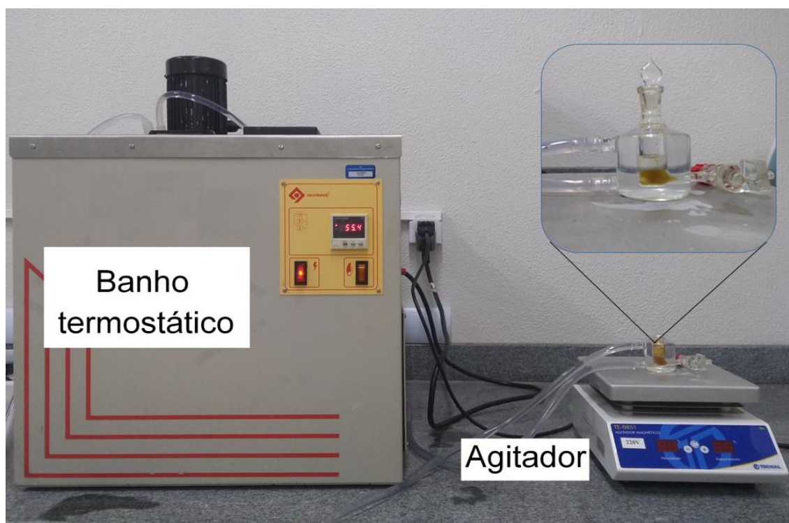
Figura 9: Sistema completo da extração líquido-líquido (LLE) composto por banho termostático, agitador + placa aquecedora e frasco de vidro encamisado.
