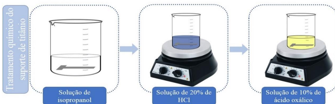
Figura 4: Ataque químico do suporte de titânio para remoção de gorduras e da camada de óxidos/hidróxidos do suporte de titânio.
