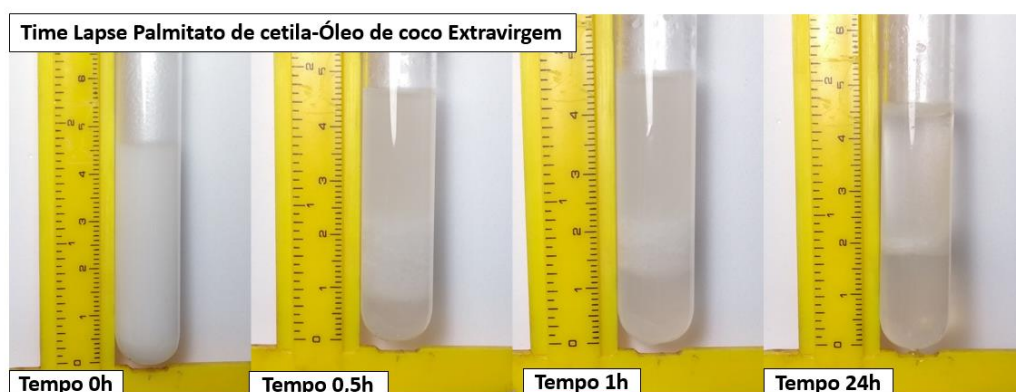
Figura A.2.6. Testes para atividade emulsificante utilizando óleo de coco virgem como substrato e palmitato de cetila como emulsionante.
