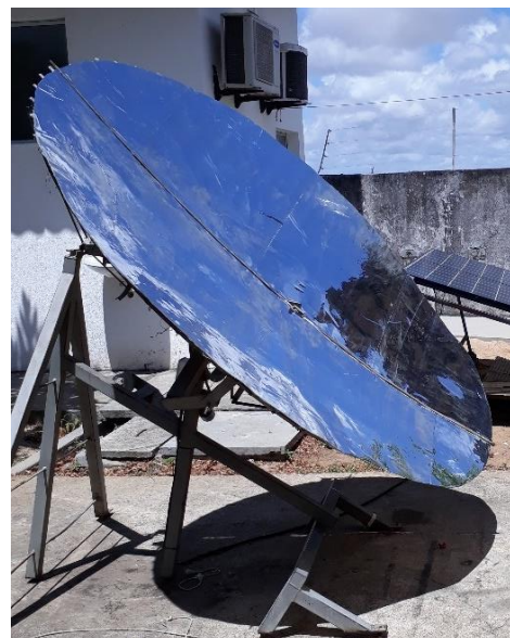
Figura 25: Área total reflexiva do concentrador de foco fixo Scheffler revestida com FRP (AUTOR, 2017).
