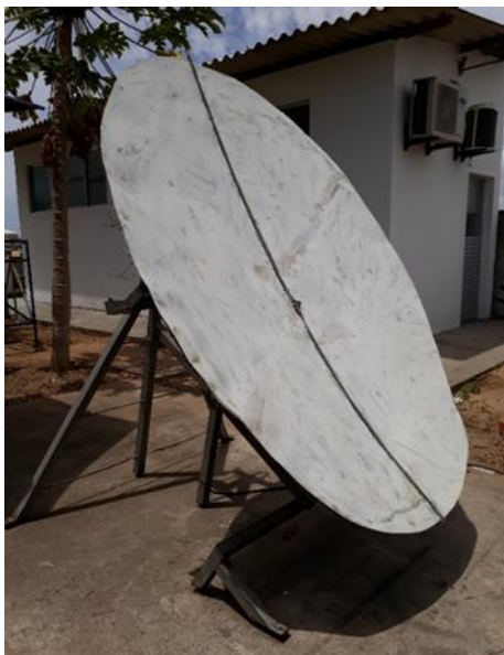
Figura 24: Concentrador solar com refletor em fibra de vidro sem revestimento FRP (AUTOR, 2017).
