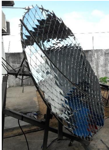
Figura 23: Concentrador de foco fixo Scheffler com a área total reflexiva revestida com EV durante experimento (AUTOR, 2017).
