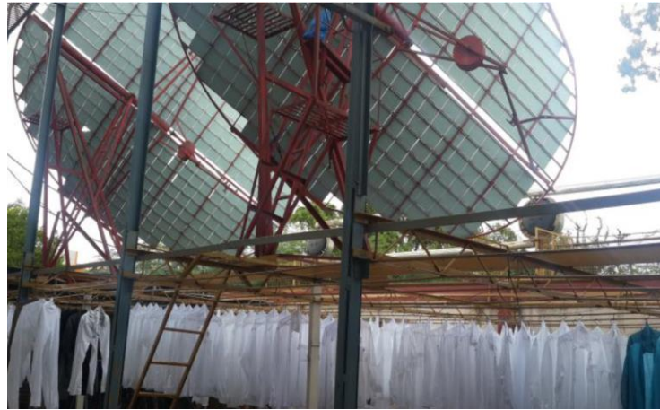
Figura 18: Concentrador foco fixo do tipo Scheffler utilizados nos experimentos em Nagar na Índia , para lavagem a seco de roupas da comunidade (BHASME, 2015).
