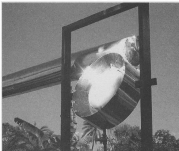
Figura 17: Absorvedor com volume de 11 litros e visor solar com diâmetro de 30 cm (PAHISSA, 2014).
