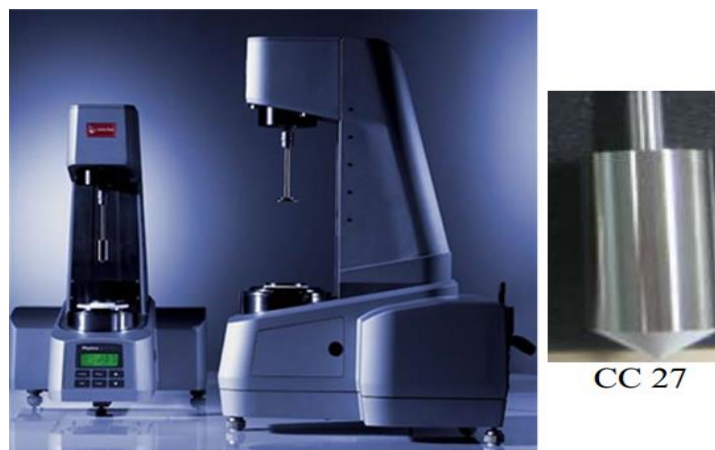
Figura 6: Reômetro Physica MCR 301 da Anton Paar e geometria utilizada: CC (cilindro coaxial). Os numerais que seguem os prefixos indicam o diâmetro (mm) da geometria.
