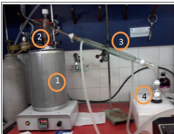
Figura 4.1. Sistema utilizado para a pirólise composto: forno elétrico (1), Reator (2), condensador (3) e balão para coletar o bio-óleo (4)
