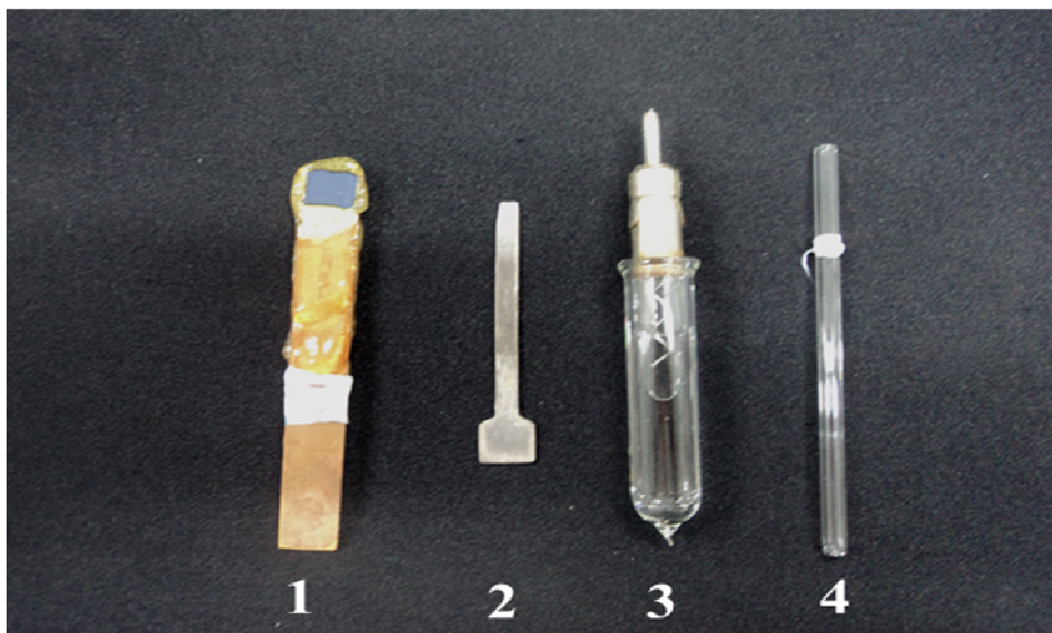
Figura 5: Eletrodos utilizados na célula eletroquímica, sendo: (1) eletrodo de trabalho, (2) eletrodo auxiliar, (3) eletrodo de referência e (4) borbulhador.
