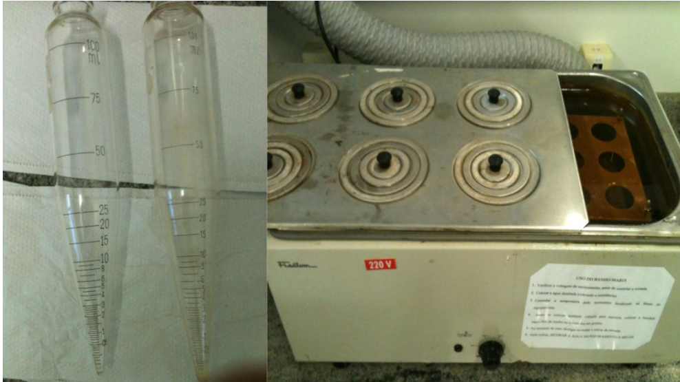
Figura 9: Tubos graduados e aquecimento convencional de Banho-Maria utilizados nos testes de estabilidade.
