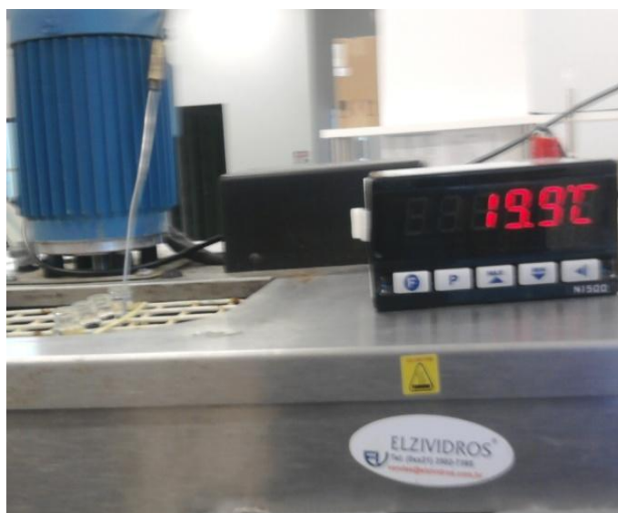
Figura 4. Aparato experimental para medidas de equilíbrio de fases líquido-líquido envolvendo heptano e diferentes líquidos iônicos.
