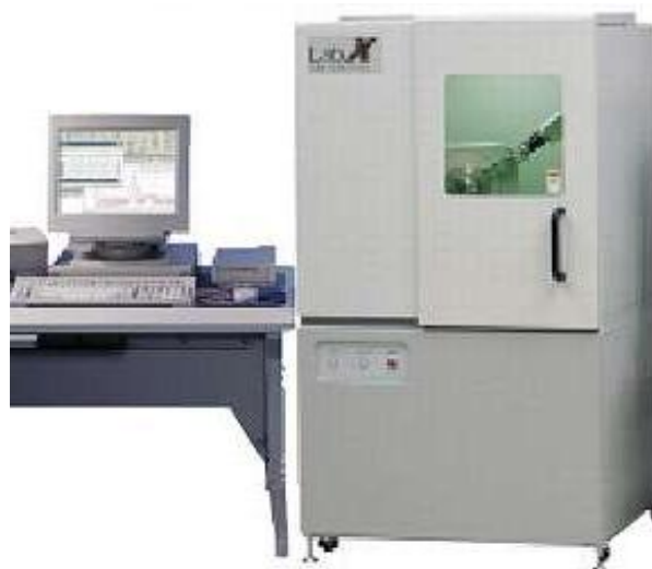
Figura 8: Difratorômetro Shimadzu modelo XRD-6000.
