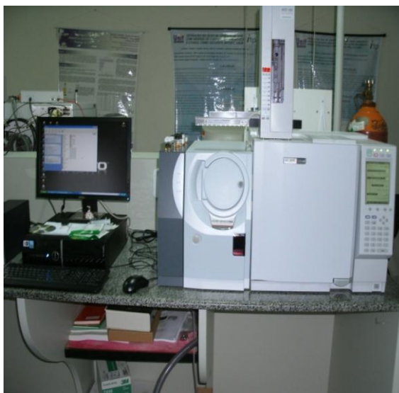
Figura 12: Cromatógrafo gasoso modelo GC/qMS Shimadzu 17 com detector de massas (QP – 5050A) do LTTL/ITP.
