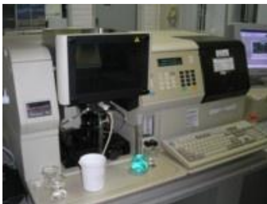
Figura 7: Espectrômetro de absorção atômica do laboratório de absorção atômica do Centro de Pesquisa e Desenvolvimento – CEPED, em Camaçari no Estado da Bahia.
