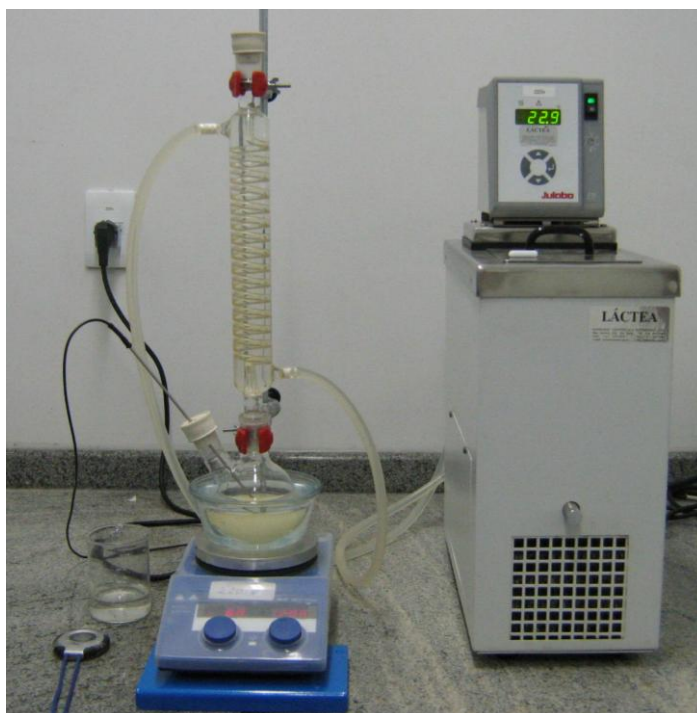
Figura 21: Sistema utilizado nas reações com aquecimento convencional.
