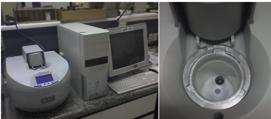
Figura 24: Micro-ondas monomodo da marca CEM, modelo Discover com detalhes da cavidade única que recebe a emissão das ondas.
