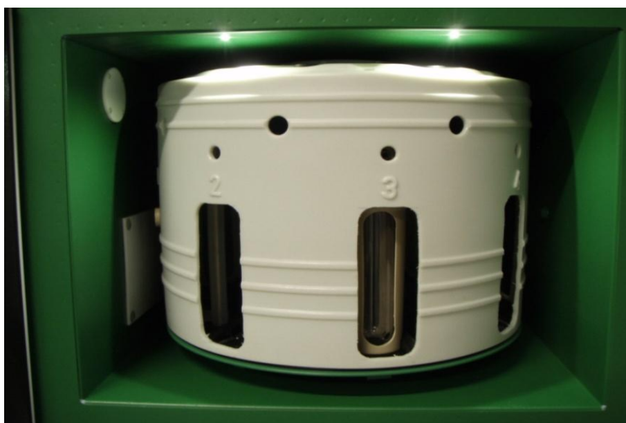
Figura 30: Cortes da capa externa do rotor e na cápsula de suporte do reator.
