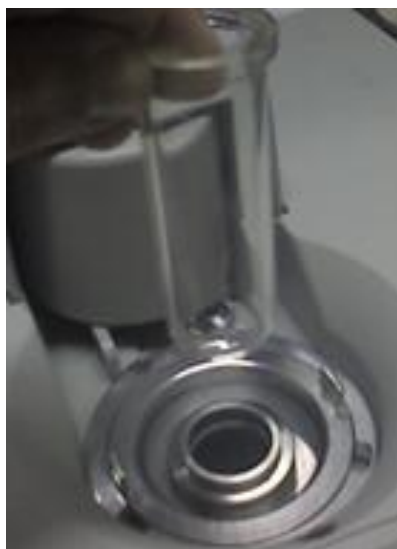
Figura 37: Frasco de 35 mL utilizado para as reações no micro-ondas monomodo.
