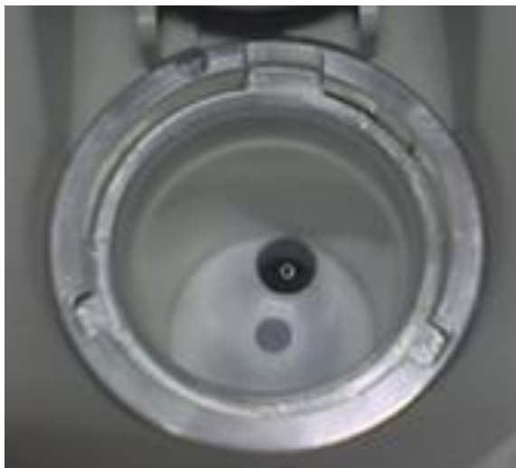
Figura 36: Habitáculo do frasco no reator monomodo com único ponto de agitação e sete pontos de emissão de ondas centralizados.
