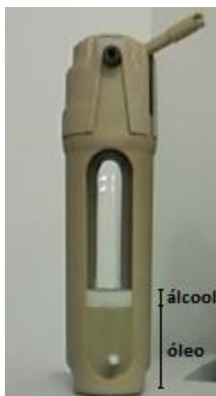
Figura 31: Detalhe do corte da cápsula de suporte e a evidência da falta de homogeneização dos reagentes no meio reacional.
