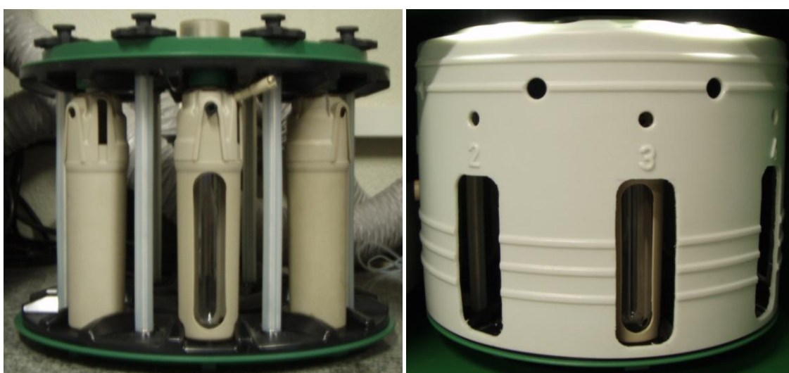
Figura 23: Adaptações realizadas na capsula de suporte e na capa externa do rotor para acompanhamento visual das reações.
