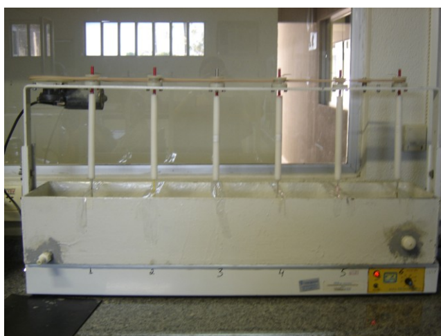
Figura 23 – JAR-TEST modificado utilizado no ensaio de variação do potencial de circuito aberto do LEM-ITP/UNIT.
