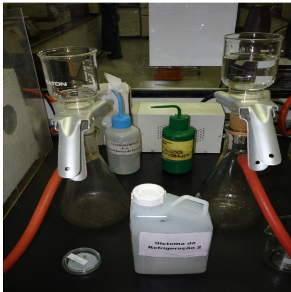
Figura 21 – Vidraria e filtro de membrana utilizados para a obtenção do TSS das amostras de água produzida.
