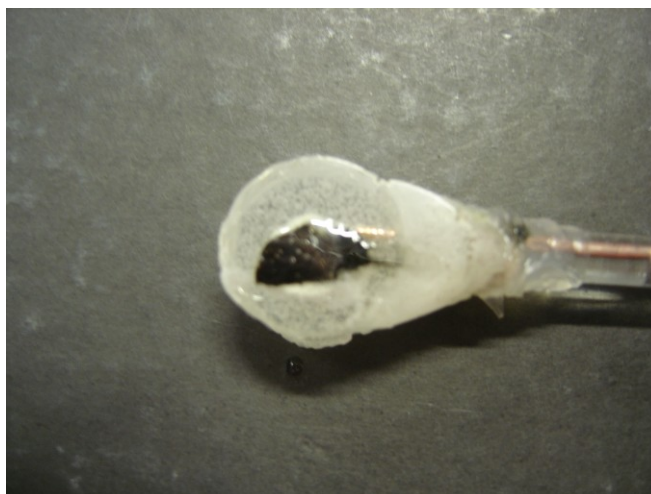
Figura 53 – Foto do eletrodo de quasicristal AlCuFe após a realização do ensaio 6 de resistência de polarização linear.
