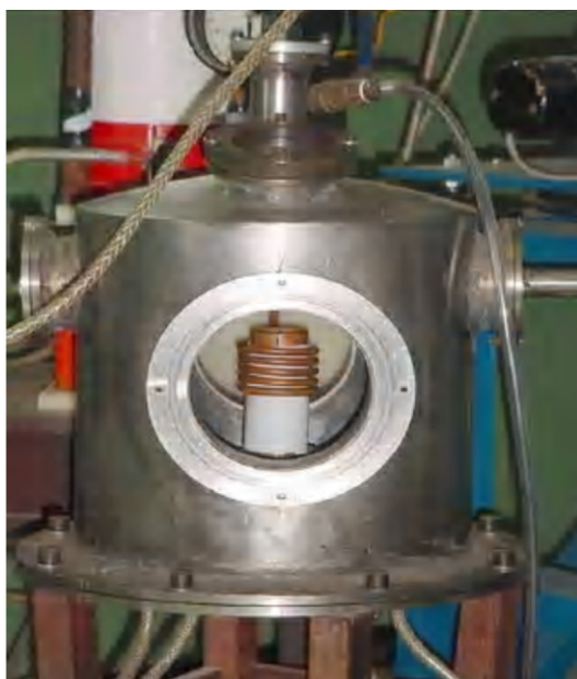
Figura 11 – Forno de indução de alta frequência da DEM/UFPB (MELO et al. , 2006).
