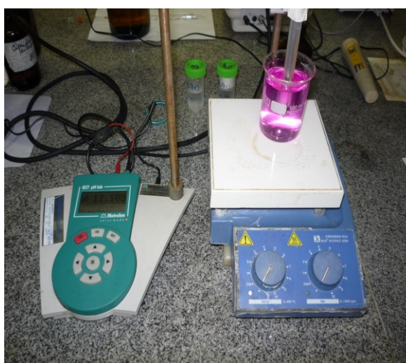
Figura 19 – Medidor de pH e agitador magnético do laboratório de análise de água de Carmópolis.
