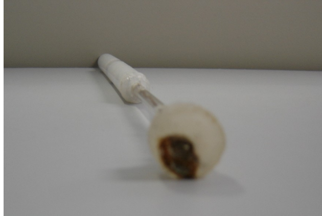
Figura 41 – Eletrodo de trabalho com a liga quasicristalina AlCuFe utilizado no ensaio de acompanhamento do potencial de circuito aberto.
