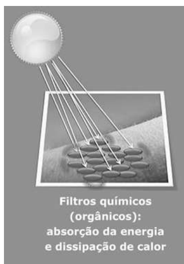
Figura 3. Mecanismo de ação dos filtros orgânicos. Extraído e adaptado de: CRIADO et al., 2012.
