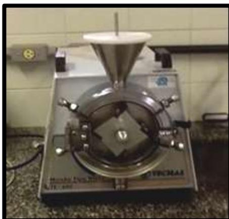
**FIGURA 16:** Moinho de facas utilizado para obtenção do granulado da casca de *Punica Granatum* Linn
