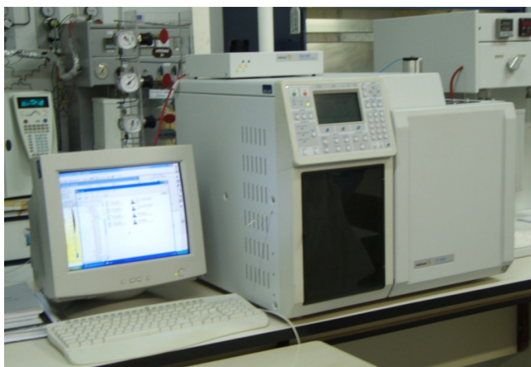
Figura 12: Cromatógrafo gasoso - Marca VARIAN modelo CP-3800.
