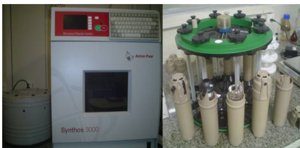
Figura 10: Reator micro-ondas Synthos 3000 e base giratória e tubos de quartzo
