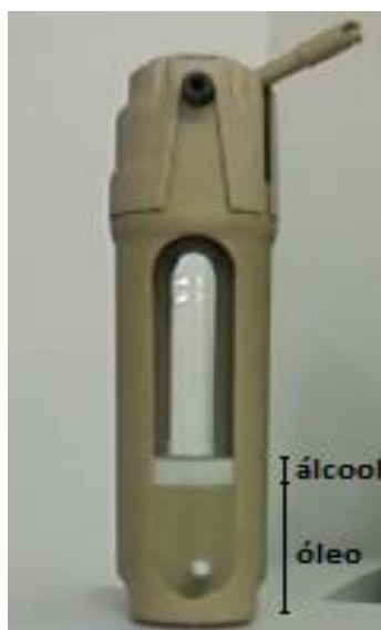
Figura 16: Detalhe evidenciando a não homogeneização dos reagentes no meio reacional.
