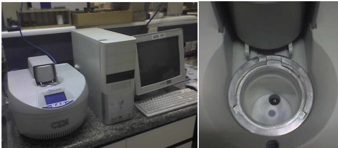
Figura 11: Micro-ondas CEM, modelo Discover com detalhes da cavidade única.
