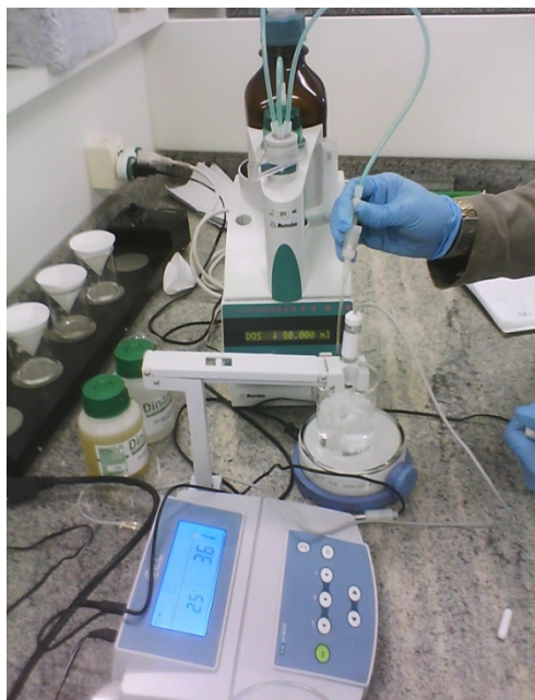
Figura 13: Titulação para determinação da densidade ácida dos catalisadores.
