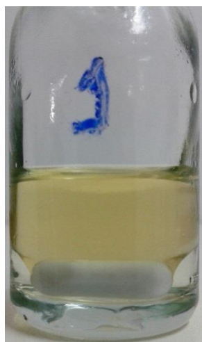
Figura 3.5 Água formada ao fundo após a reação do Teste 8 com etanol. Condições: RM = 5, 2% (m/m total ) H 2 SO 4 , 50 °C e 6h.
